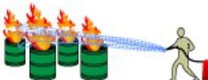
Olio e benzina accesi, situati in contenitori aperti, non vanno mai spenti usando l'estintore dall'alto, ma orientando il getto dell'estintore sul bordo del contenitore, cercando di rompere la fiamma per permettere il soffocamento dell'incendio.
